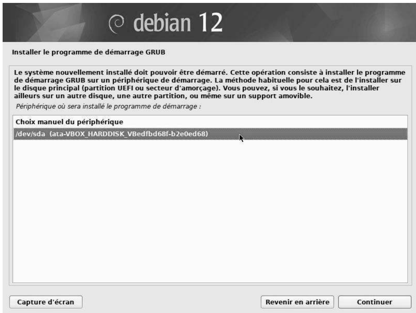
Installation : choix du disque pour GRUB
